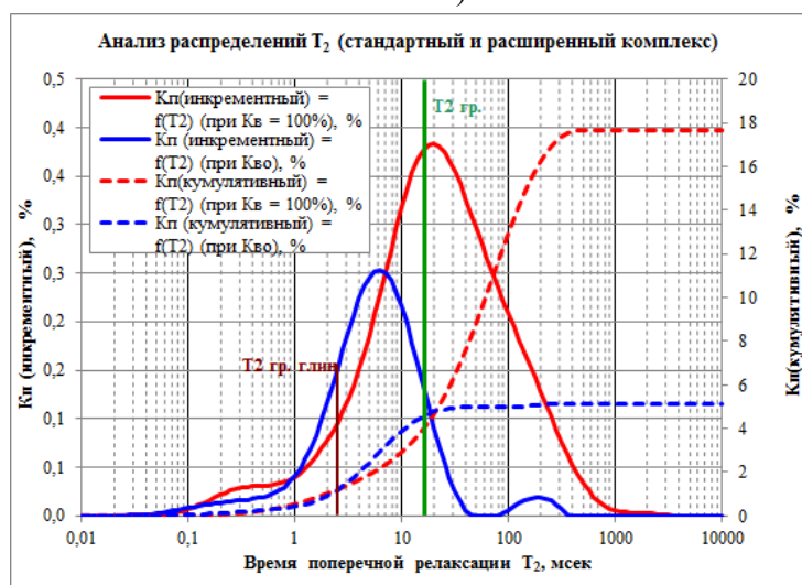
Распределение времени T_2 (ЯМР) для обр. № N-1. Месторождение Лесное, скважина 1-СХ
