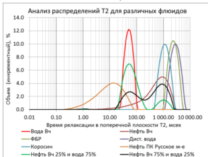
Распределение времени T_2 (ЯМР) для обр. № N-1. Месторождение Лесное, скважина 1-СХ
